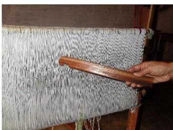
uma espécie de gancho em uma das extremidades, utilizada para *urdir* no *Tear de Três Panos*, sem ela o urdimento não é possível, é introduzida no pente perpassando os espaçamentos entre *liços* e talas ou ferros do pente, para lançar o fio de algodão trazido
