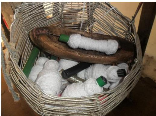
Figura 5 – Lançadeira e canela
