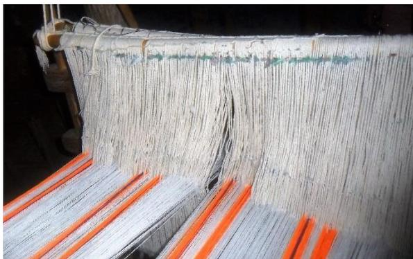
de madeira, lisas e finas, na largura do tear, para dar suporte à teia de fios grossos de algodão, que formam os *liços*, foto, à esquerda; depois de prontos são encaixados nas armações do tear que se ligam às *pisadeiras* e são utilizados para abrir e fechar o *urdume*, formando calas
