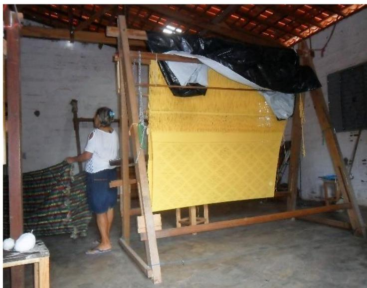
33. *Tear de Três Panos* – equipamento feito de madeira, com estrutura composta por quatro
