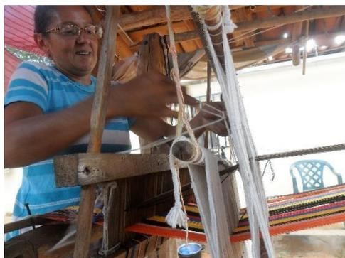
mesmo espaço do *liço* e *penete*, durante o processo de urdimento da Rede de Três Panos. Necessário se faz tirar a pareia e reparar-se o erro durante a tessitura do pano, a fim de evitar falhas no tecido. Na foto, Socorro Alves Brandão, tirando uma pareia de um urdimento de um pano, localidade Aroeira.
