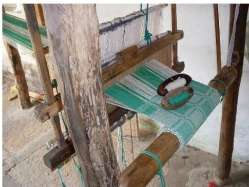
regulam a largura desejada do Tear, feitos artesanalmente de madeira lisa, roliça e resistente para compor o *Tear de Três Panos*. São utilizados dois rolos por tear, um frontal, onde o *teçume* vai sendo enrolado, e um outro, do lado oposto, ao fundo, chamado rolo urdidor, de onde saem os fios da urdidura que receberam a *trama*. Têm a função
