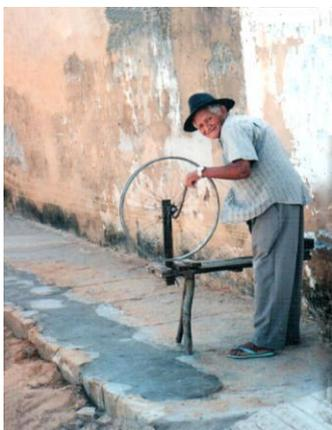
Para *fazer ou torcer punho* usa-se também o engenho de fazer punho, uma “máquina”, resultante de um carretel adaptado com uma calha de pneu de bicicleta acoplada a um banco de madeira. Na foto, flagrante em uma calçada da rua Corinto Andrade, bairro Santo Antônio, Sr. Cícero Pedro, 87 anos, torce punhos para vender, diz estar na atividade há mais de 60 anos.
