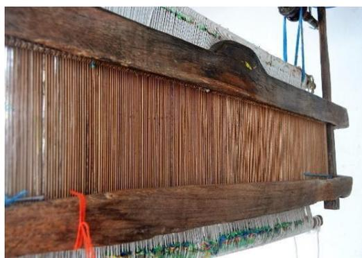
se apresenta na forma de uma moldura retangular de 80 cm de largura por 0,25 de altura feito com talos de palmeira – babaçu, buriti, ou talhinhas de tabocas de bambu presas nas extremidades por barras de madeira, fica encaixado na queixa, por entre as talhinhas passam os fios da urdidura. No *Tear de Batelão*,
