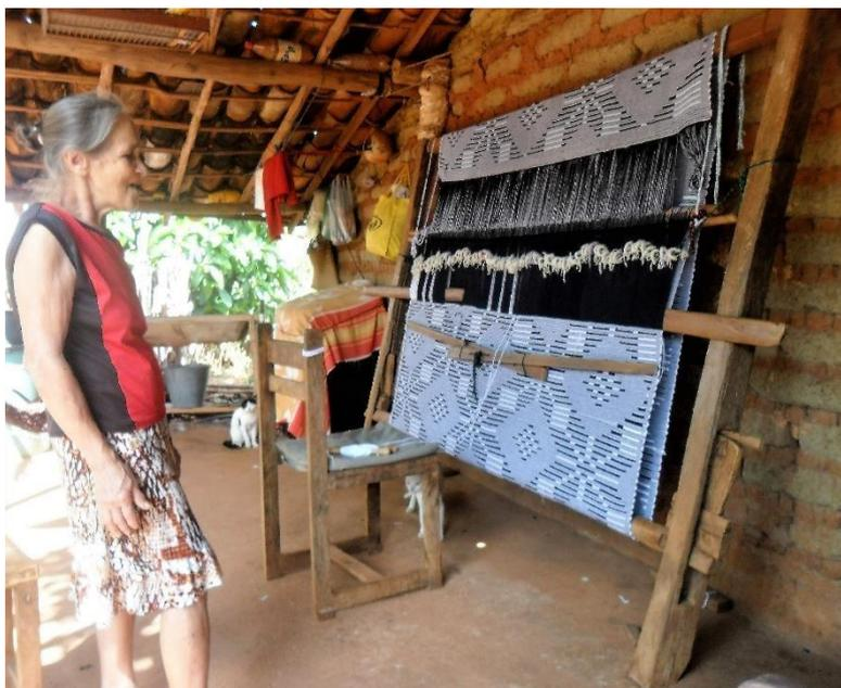
32. *Tear de Grade* – tem todas as características do *Tear de Parede*, adicionado de um suporte de encosto que dispensa o uso da parede ou estrutura com objetivo semelhante. Na foto, Isabel Sousa, a ‘D. Biluca’, bate uma rede recém tirada do *Tear de Grade*, na Associação Artesanal Xique – Xique de Pedro II.
