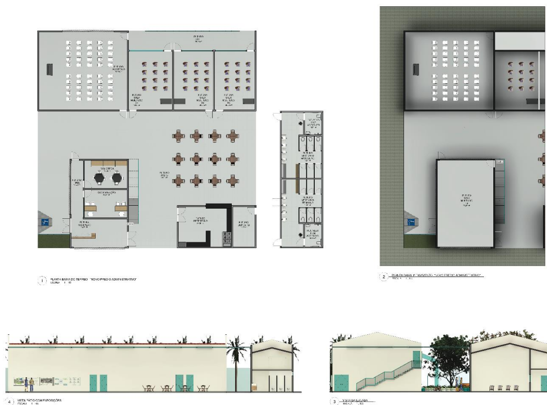
Figura 82 Planta baixa do térreo, 1º Pavimento e Vistas do "Novo Prédio Administrativo".
